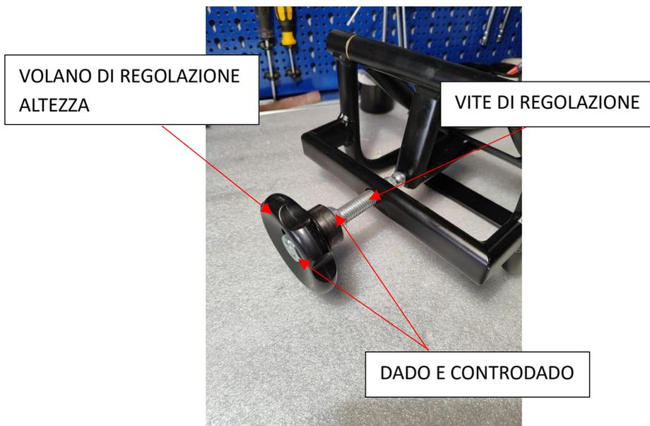
Eseguita l'operazione precedente, potete assicurare alla vite di regolazione il volano di regolazione altezza serrandolo tramite il dado ed il contro dado fornito all'interno della confezione.
