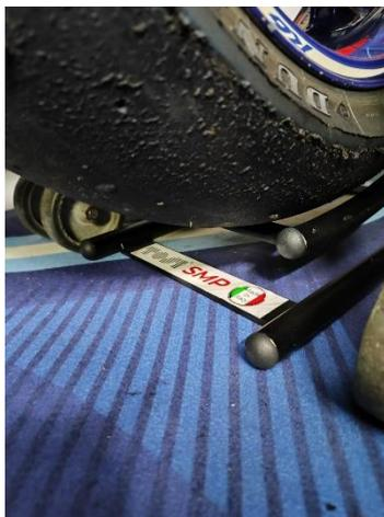
A questo punto è possibile eseguire lo smontaggio del perno della ruota posteriore senza che la ruota abbia la possibilità di muoversi e di conseguenza senza dover utilizzare le mani per sostenerla. SMP in questo momento sta svolgendo il lavoro che, altrimenti, dovrete svolgere voi.
