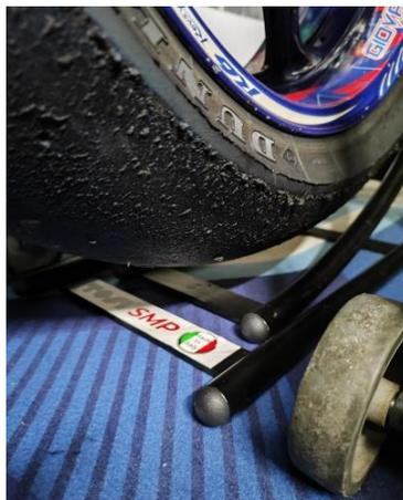
Avvitare il volano del sistema SMP in senso orario fino a che non si percepisce una certa resistenza e fino a quando la parte mobile non aderisce allo pneumatico posteriore.
