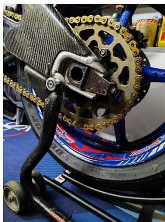
Ruotare in senso antiorario il volano per abbassare l'altezza di regolazione SMP e per far sì che la ruota scenda verso il basso.
